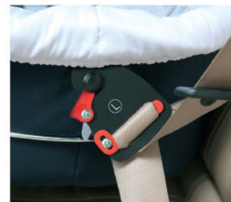
Detalle del sistema de anclaje de los cinturones del coche.
